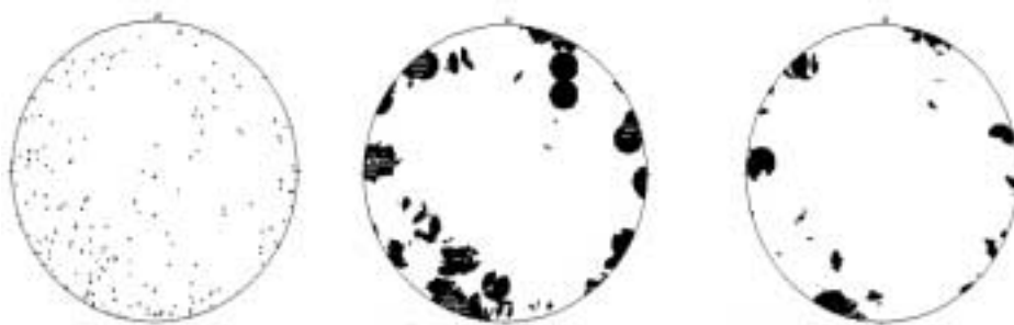
Fig. 1.- Distribución de los polos de los planos extensionales en red de Schmidt: todos los planos en primer lugar y con intervalos del 2% y del 3% después. Salidas gráficas obtenidas con el programa GEODRE.
