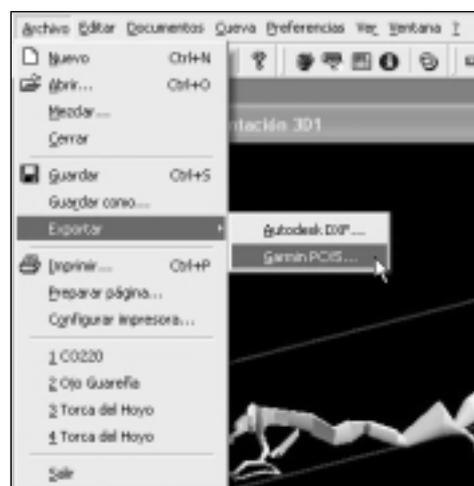
figura 9. En VisualTopo exportamos la poligonal en formato PCX5
