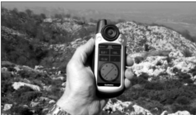
figura 1. Un receptor GPS de última generación. La antena apunta hacia el cielo (Foto C. Puch).
